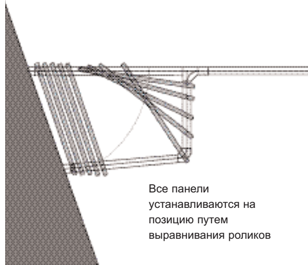
Парковка в боксы Только передвижные панели или только панели- двери двойного действия (правая или левая, или правая и левая)
